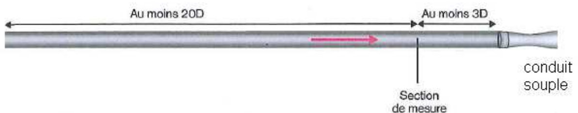
Figure 1 : Configuration de la mesure avec un conduit rigide venant remplacer le dispositif de captage.
