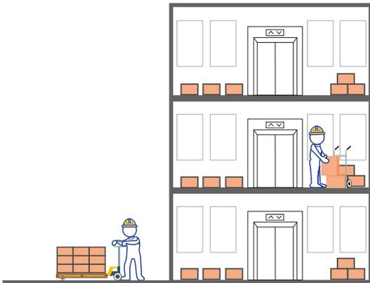
Le donneur d'ordres a prévu la mise à disposition de l'ascenseur définitif pour les besoins du chantier et des zones spécifiques de circulation sont aménagées. Les entreprises mettent à disposition de leurs salariés des équipements de manutention mécanique permettant de rouler les charges. Cependant, l'inadéquation du matériel et du conditionnement des marchandises avec les capacités de l'ascenseur (en volume et en poids) impose des reprises de charge.
