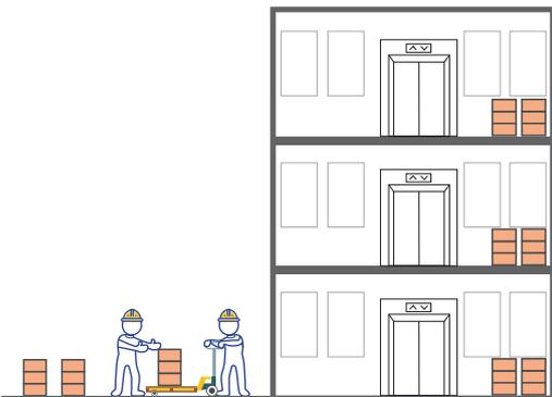
Les compagnons ont à leur disposition un ascenseur et des équipements de manutention. Les palettes livrées sur chantier sont adaptées aux caractéristiques du lift (poids et dimension).
