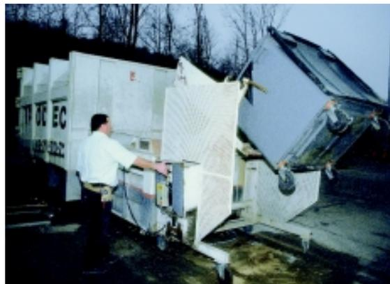
**La grille protège des projections et des pièces en mouvement.**
