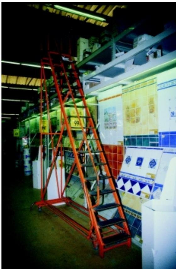
*Placer correctement et bloquer la girafe avant d'y monter.*
