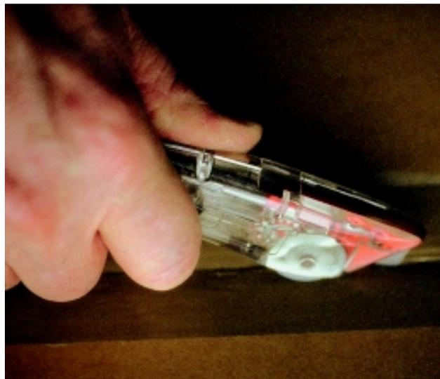
*La roulette met la lame en position de coupe. En fin de coupe, la lame se rétracte automatiquement.*
