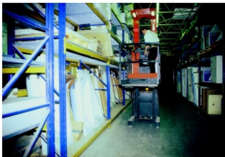
*Le prélèvement des colis avec chariot à poste de conduite élevable : un moyen sûr.*
