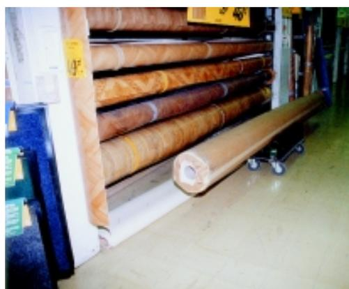
Un matériel de manutention adapté (chariot, transpalette à main, casier à roulettes, diable...) doit être mis à la disposition de chaque rayon, par exemple un berceau pour déplacer les lourds rouleaux de moquette et P.V.C ou un chariot à plateau pour les palettes de carrelage.
