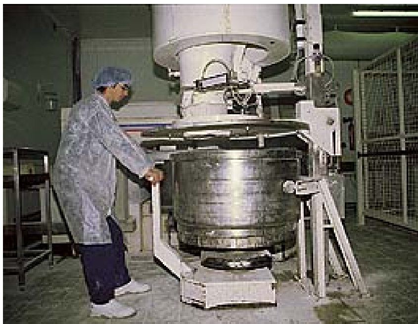
Un couvercle sur la cuve limite la dispersion de la farine.
