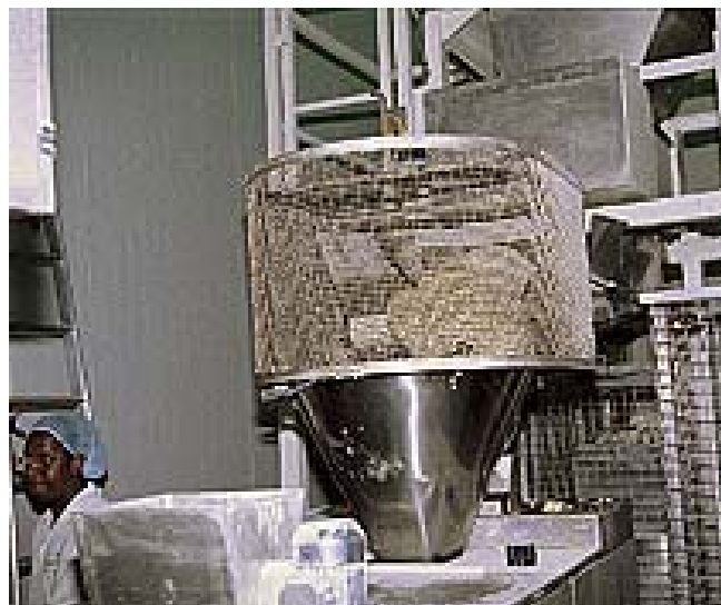
Protection de la trémie par éloignement.
