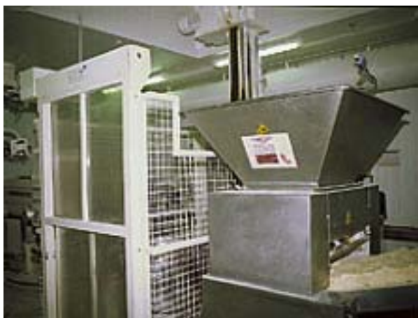
L'enceinte grillagée interdit l'accès à l'élevateur de cuves.
