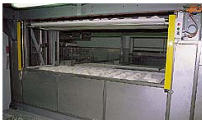
Cellules photoélectriques formant un rideau immatériel de protection .
