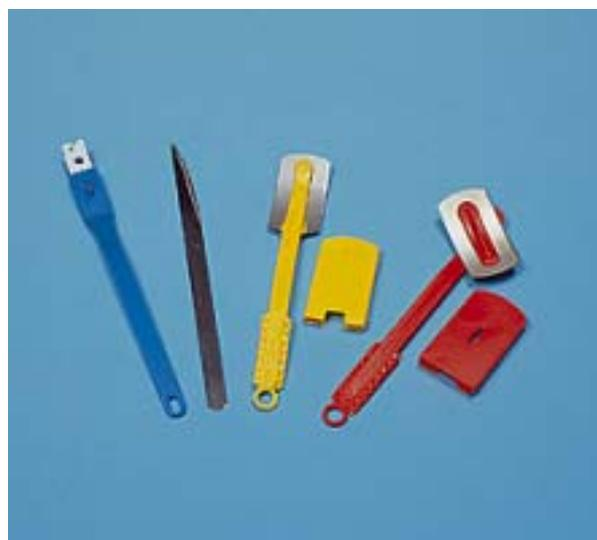
*Un scarificateur muni d'un manche éloigne les doigts de la lame.*
