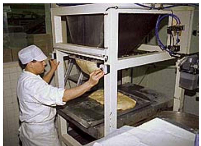
**La commande bimanuelle supprime le risque de sectionnement pour l'opérateur.**
