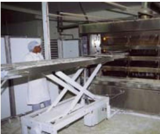
*Exemple de matériel de mise à hauteur variable.*
