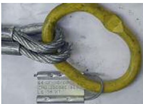
Fig 41 – Plaque de charge d'une élingue deux brins
