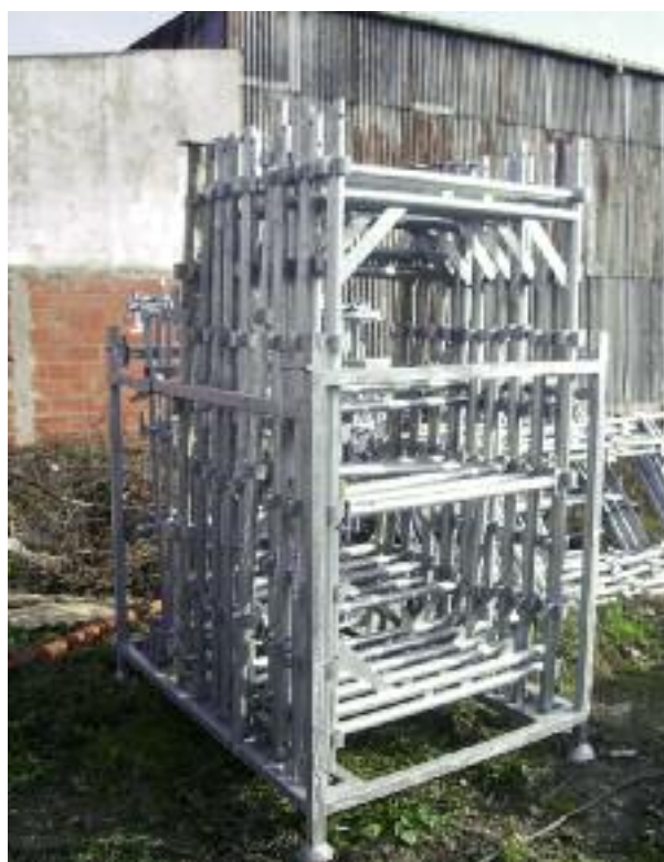
Fig. 34 – Rack de stockage pour les éléments d'échafaudage
