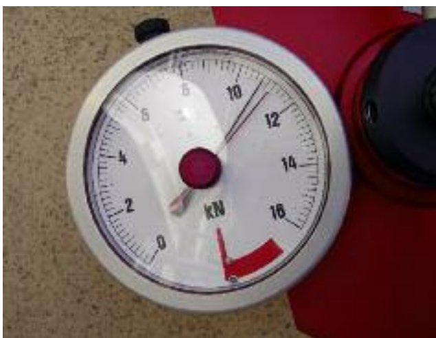
Fig.3 – Lecture directe de la capacité de traction sur l'appareil de contrôle
