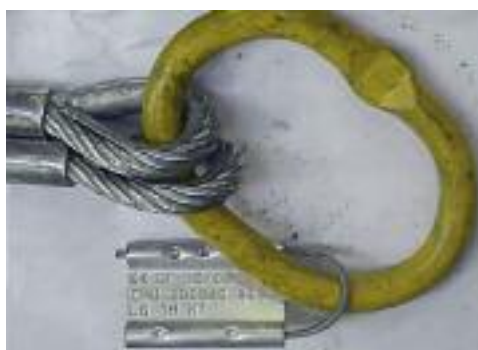
Fig 41 – Plaque de charge d'une élingue deux brins
