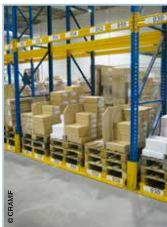
Supports constitués de palettes avec deux références par emplacement
