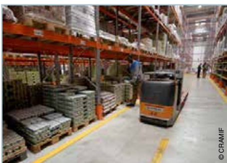
Emplacements standards dont la lisse ne génère pas de contrainte posturale
