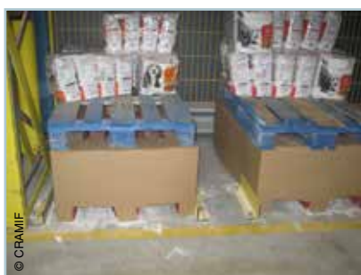
Supports de palettes espacés facilitant la prise des colis par les côtés
