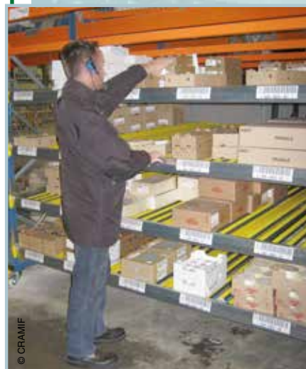
Dynamique à 4 plans de stockage
