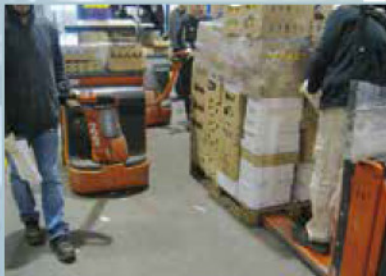
Filmage en allée de préparation : risque supplémentaire de heurt par un engin
