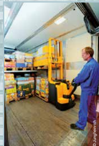
Dépôt simultané des palettes sur le plancher et sur les barres du camion à l'aide d'un gerbeur à double fourche.
