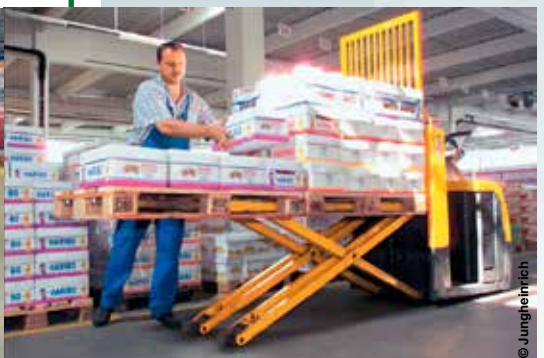
Transpalette autoporté à «longue fourche» élévable (2 palettes) muni de croisillon de maintien
