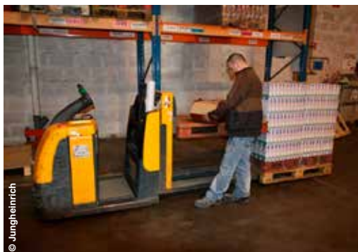
Transpalette autoporté «longue fourche» (2 palettes) avec la fonction haute levée sur une seule palette
