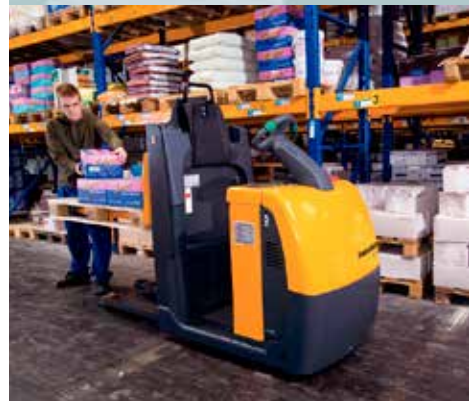
Transpalette autoporté à simple fourche élévable (1 palette)
