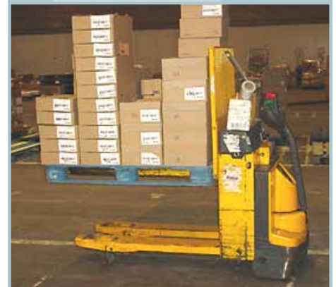
Transpalette à conducteur accompagnant avec fourche élevable (utilisé sur de faible distance de déplacement)
