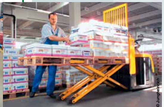
Transpalette autoporté à «longue fourche» élevable (2 palettes) muni de croisillon de maintien
