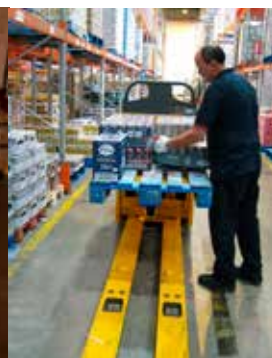
Transpalette autoporté «longue fourche» (2 palettes) avec la fonction haute levée sur une seule palette
