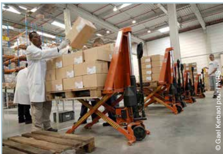
Transpalette manuel avec levée électrique des fourches
