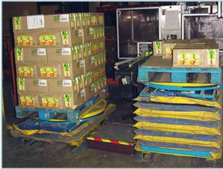
Approvisionnement des lignes de conditionnement à l'aide de tables à hauteur constante
