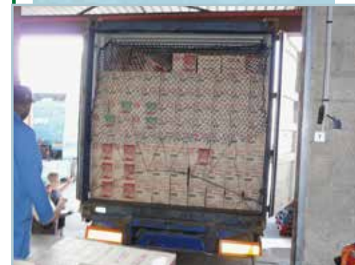
Filet tendu retenant les premières piles de colis
