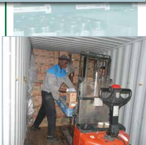
Transpalette gerbeur permettant d'élever le plan de pose
