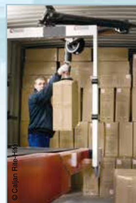
Convoyeur équipé d'un système d'aide à la manutention par ventouse
