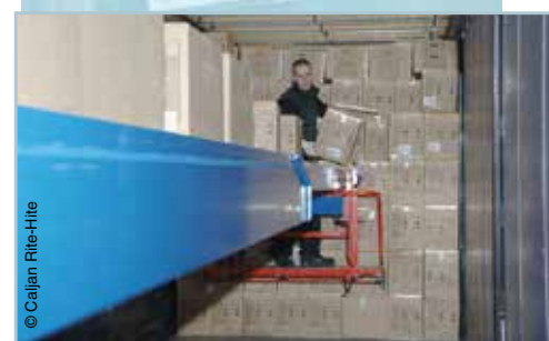
Convoyeur équipé d'une plate-forme solidaire permettant d'atteindre les colis les plus hauts
