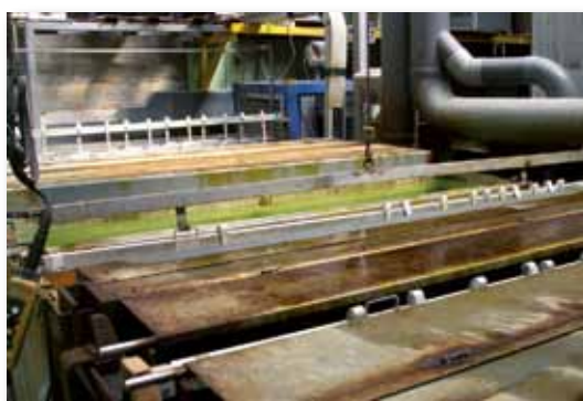
Photo 7 et 8 - Cuves avec aspiration et couvercle
