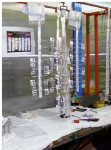
Photo 10 - Utilisation d'absorbant jetable sur une table d'attache
