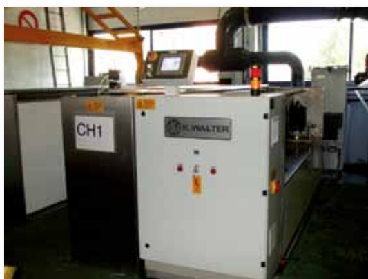
Photos 21 et 22 - Cuves avec aspiration et couvercle, à double compartiment superposé : - les pièces sont introduites alors que le bain se trouve isolé dans le compartiment inférieur
