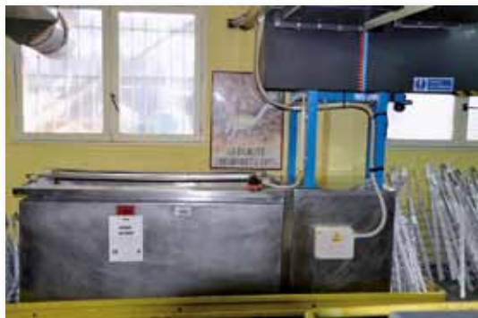
Photo 18 - Étuve pour le séchage des pièces
