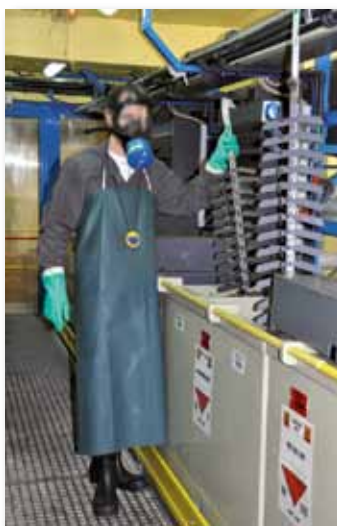
Photo - 12 Port des EPI
