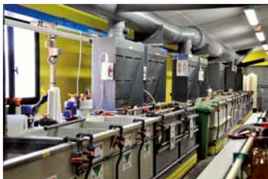
Photo 7 et 8 - Cuves avec aspiration et couvercle
