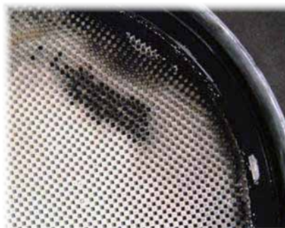
Vue des taches noires après démontage du média filtrant
