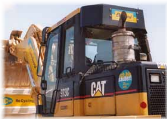
Filtres montés à l'extérieur
