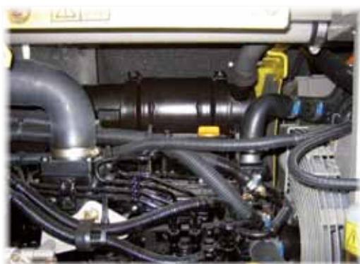
Filtres montés sous le capot moteur
