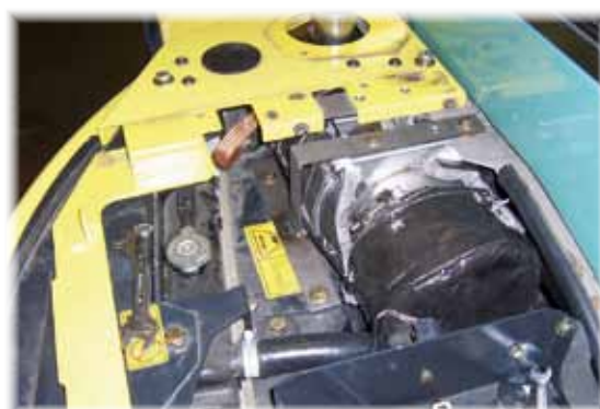
Filtres montés sous le capot moteur
