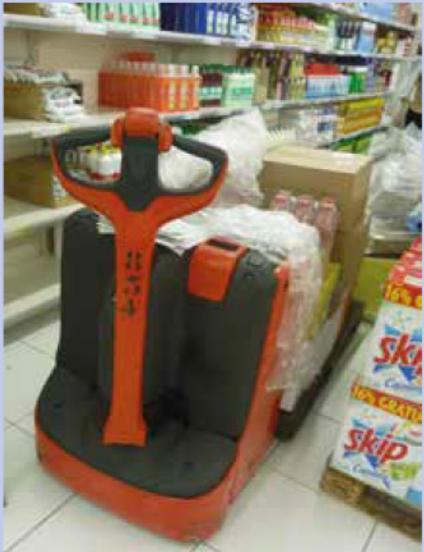
Transpalette électrique à levée auxiliaire
