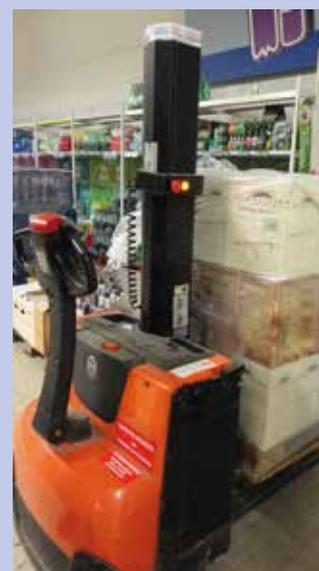
Transpalette électrique à levée auxiliaire
