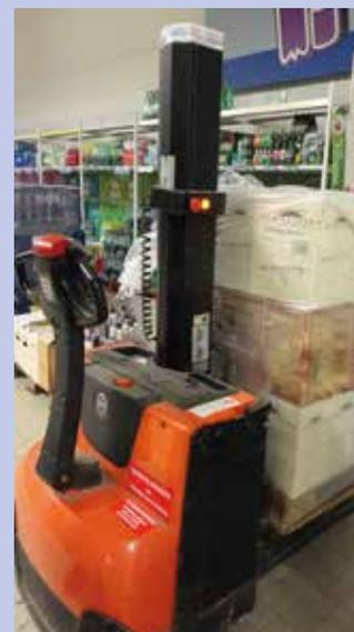
Transpalette électrique à levée auxiliaire
