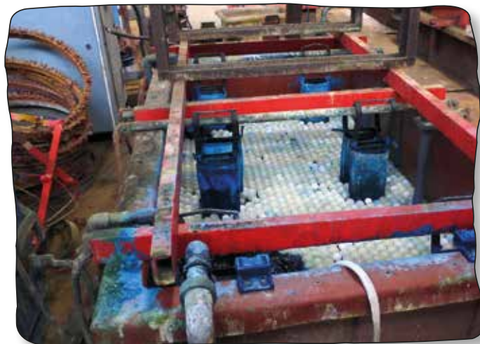
La mise en place de billes limite la surface d'évaporation
