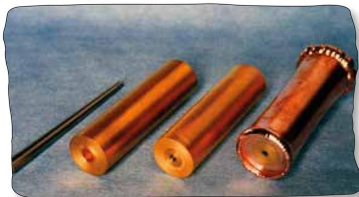
Peu de métaux sont électroformés (nickel, cuivre, or...), mais le nickel est de loin le plus utilisé en raison de sa bonne tenue mécanique et de sa résistance à la corrosion et à l'usure.
