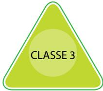
Une alimentation en TBTS (24V) avec un transformateur d'isolement est systématiquement utilisée lors d'activité dans des emplacements conducteurs (humidité) ou exigus. Dans ce cas de figure, le matériel d'éclairage est de classe 3.
