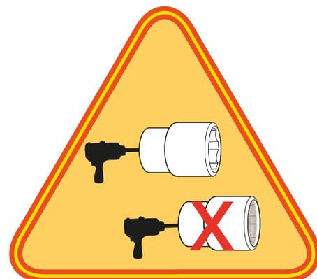
Douille neuve / douille usagée
