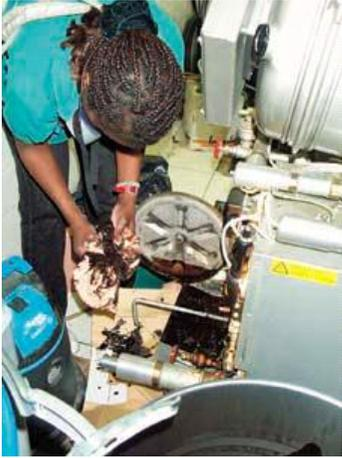
Les boues non distillées sont évacuées régulièrement du fond du distillateur manuellement (cf. photographie ci-contre) ou automatiquement (machines les plus récentes)\*. Le raclage des boues manuel et le nettoyage du distillateur exposent au perchloréthylène.
