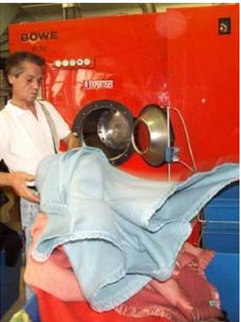
Un séchage insuffisant (durée de séchage insuffisante, chargement de machine trop important ne permettant pas un séchage complet) peut entraîner une exposition au perchloréthylène lors de l'ouverture du hublot et le chargement du linge.
