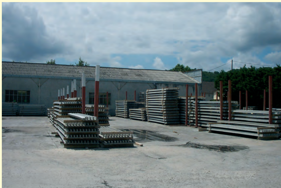
Poteaux pour support des stocks de poutrelles
